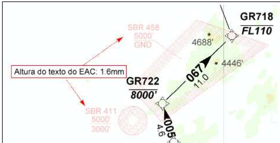
Figura 24 - Espaços Aéreos Condicionados
